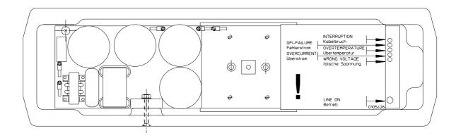
Leuchtet beim Einschalten des IRFUN eine der roten Leuchtdioden auf, so hat sich der IRFUN wegen eines erkannten Fehlers abgeschaltet.
