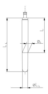
Längen L und  $\mathbf{L}_{\mathbf{L}}$  am Ende Gehäuserohr messen (Ausgangsmaß)
